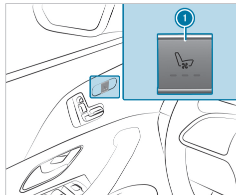
Ventilation de siège dans le poste de conduite
