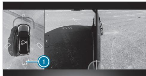
Vue latérale des caméras rétroviseurs extérieurs dans la vue de la remorque (exemple)
