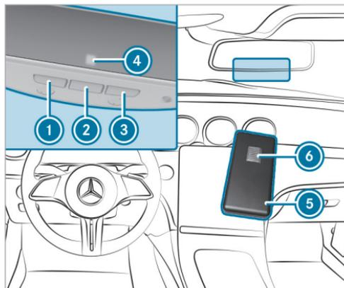
▶ Vérifiez que la fréquence d'émission de la télécommande se trouve dans la plage de fréquences comprise entre 280 et 868 MHz.
