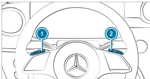
Lorsque la boîte automatique se trouve sur **D**, vous pouvez changer de rapport manuellement en utilisant les palettes de changement de rapport au volant. Dans la mesure où un changement de rapport est permis, la boîte automatique engage, en
