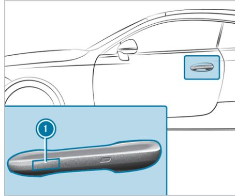
► **Verrouillage et déverrouillage du véhicule avec la fonction NFC:** maintenez immobile la clé de véhicule digitale contre la poignée de porte au niveau de l'antenne NFC ❶ pendant 5 à 10 secondes environ à une distance maximale de 0,4 in (1 cm).
