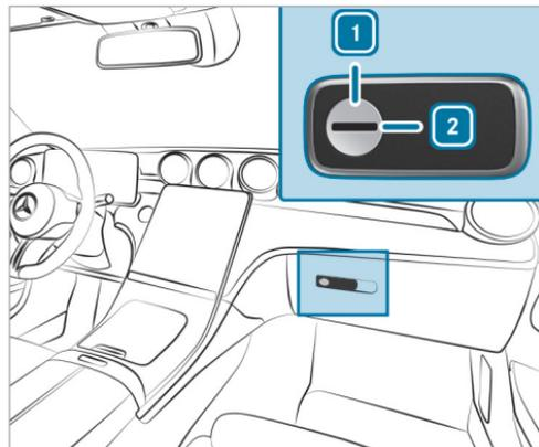
▶ Tournez la clé de secours d'un quart de tour vers la droite 2 (verrouillage) ou vers la gauche 1 (déverrouillage).
