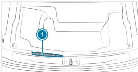
L'anneau de remorquage ① se trouve sous le plancher de coffre, dans le seuil de chargement.
