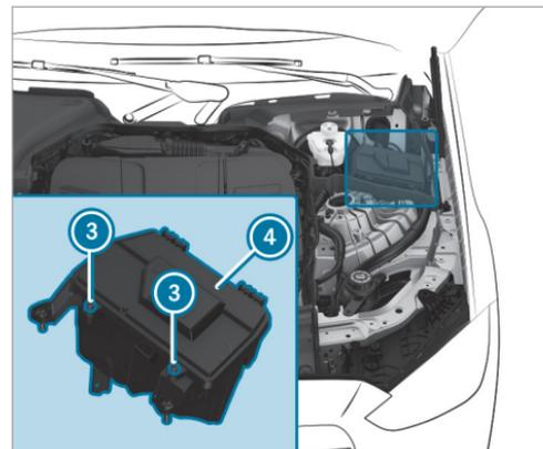
▶ Le cas échéant, éliminez les traces d'humidité sur la boîte à fusibles avec un chiffon sec.
