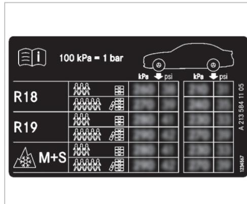
Certains tableaux de pression des pneus mentionnent uniquement le diamètre des jantes (R18, par exemple) à la place des dimensions de pneus complètes. Le diamètre des jantes est indiqué dans les dimensions des pneus. Relevez le diamètre des jantes indiqué sur le flanc du pneu (→ page 406).
