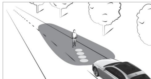
La fonction spot fonctionne en arrière-plan et signale par quatre brefs clignotements des phares les personnes détectées à l'intérieur de la ligne de délimitation de la voie. Le conducteur est aussi averti par une projection du symbole sur la position de la personne.
