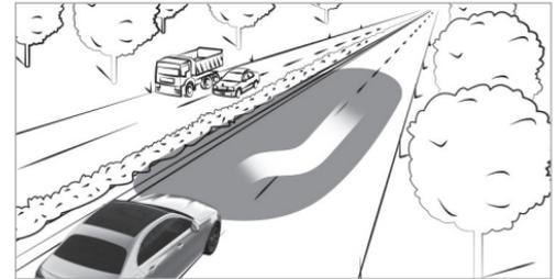
A une vitesse égale ou supérieure à 19 mph (30 km/h), le tracé du changement de voie est signalé par un clignotement en cas de changement de voie assisté.
