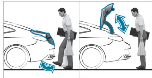
La fonction HANDS-FREE ACCESS vous permet d'ouvrir, de fermer ou de stopper le couvercle de coffre d'un mouvement du pied sous le pare-chocs. Pour cela, la boîte de vitesses doit se trouver sur **P**.
