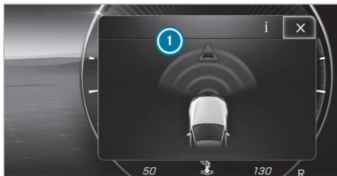
Lorsqu'un freinage autonome ou une amplification de la force de freinage asservie à la situation a été déclenché, la fenêtre contextuelle ❶ apparaît sur l'écran conducteur, puis disparaît automatiquement après un court instant.
