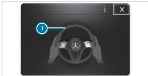
Si le système détecte que le conducteur ne dirige pas lui-même le véhicule ou qu'il lâche le volant pendant une période prolongée, une alerte optique se déclenche d'abord. L'affichage ❶ apparaît sur l'écran conducteur. Si le conducteur ne dirige toujours pas activement le véhicule ou ne donne pas de signal de confirmation au système, un signal d'alerte retentit de façon répétée en plus de l'alerte optique.
